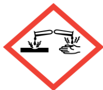
Palavra de Advertência Corrosivo
